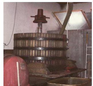
■伝統式垂直圧搾機 100年以上前に造られたもので、現在も使用している。
